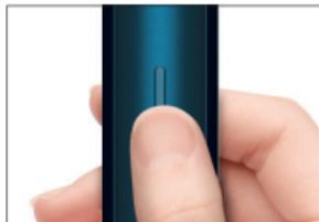
Это устройство находится в спящем режиме и не будет работать, если его не активировать перед первым использованием. Чтобы вывести устройство из спящего режима, нажмите и удерживайте кнопку в течение 2 секунд или подключите устройство к разъему для зарядки.
