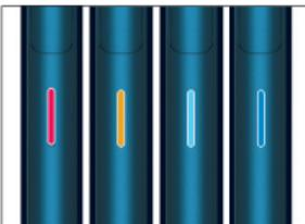
Устройство перезапускается, и светодиодный индикатор будет поочередно мигать по два раза красным, оранжевым, светло-голубым и синим цветом.
