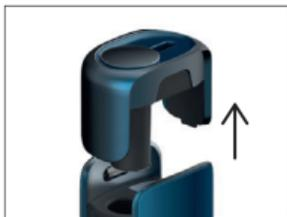
Если внутри имеются остатки использованного стика, снимите колпачок с устройства.
