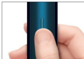
Құрылғы ұйқы режимінде тұр және бірінші рет пайдалану үшін іске қосылмағанша жұмыс істемейді. Құрылғыны бірінші қолданар алдында ұйқы режимінен шығару үшін, түймені 2 секунд басып тұрыңыз немесе құрылғыны зарядтау жалғағышына қосыңыз.
