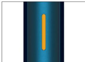
Светодиодный индикатор мигает оранжевым в течение 3 секунд. После 3 последовательных сеансов устройство будет автоматически остывать. Подождите, пожалуйста, пока температура устройства стабилизируется.
