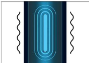
Спустя 2 секунды светодиодный индикатор мигнет светло-голубым и одновременно будет ощущаться вибрация. Приблизительно в течение 25 секунд начнется процесс предварительного нагрева. Длительность процесса предварительного нагрева может варьироваться в зависимости условий эксплуатации.
