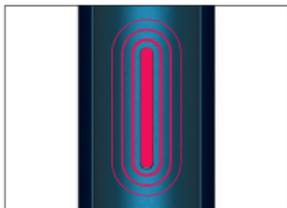
Светодиодный индикатор мигает красным 5 раз. Устройство работает ненадлежащим образом. Перезапустите устройство.
