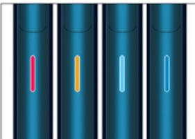
В процессе выхода из спящего режима светодиодный индикатор будет поочередно мигать по два раза красным, оранжевым, светло-голубым и синим цветом.
