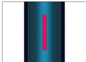
Светодиодный индикатор горит красным в течение 3 секунд, и одновременно устройство вибрирует 3 раза. Батарея недостаточно заряжена. Зарядите устройство.
