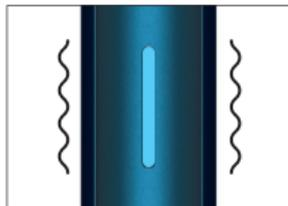
Когда устройство полностью перезапустится, светодиодный индикатор состояния будет гореть светло-голубым в течение 1 секунды и одновременно устройство дважды завибрирует.
