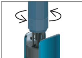
Вставьте скребок в устройство и очищайте устройство посредством вращения скребка.
