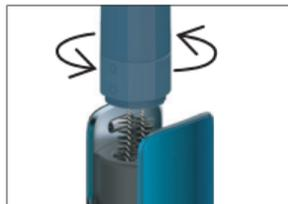
Вставьте щетку в устройство и очищайте устройство посредством вращения щетки.
